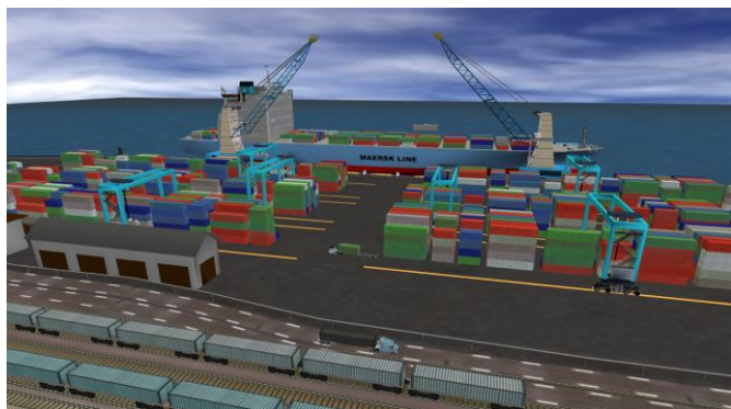
Rys. 3. Morski terminal kontenerowy: model w programie FlexSim/Flexterm.
